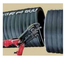
Couper la spirale métallique en acier. Le fil ne doit pas dépasser l'extrémité du tuyau
