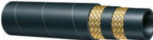
**ISO 11237 - EN 857 2SC****Tube:** caoutchouc synthétique résistant à l'huile.**Renforcement:** deux tresses acier haute résistance.**Couverture:** caoutchouc synthétique résistant à l'ozone, à l'abrasion et aux hydrocarbures.**Utilisation:** circuits hydrauliques haute pression pour carburants, anti-gel, eau ou air.**MELANGE SANS HALOGENE****Températures:** -40 °C +100 °C (-40 °F +212 °F)
