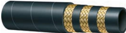
**3SPT****Tube:** caoutchouc synthétique résistant à l'huile.**Renforcement:** trois tresses acier haute résistance.**Couverture:** caoutchouc synthétique résistant à l'ozone, à l'abrasion et aux hydrocarbures.**Utilisation:** circuits hydrauliques très haute pression, pour carburants, anti-gel, eau ou air.**Températures:** -40 °C +100 °C (-40 °F +212 °F)
