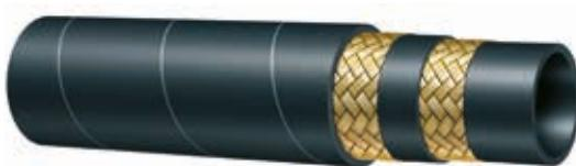
**ISO 1436-1 - SAE 100 R2AT - EN 853 2SN****Tube:** caoutchouc synthétique, résistant à l'huile.**Renforcement:** deux tresses acier haute résistance.**Couverture:** caoutchouc synthétique résistant à l'ozone, à l'abrasion et aux hydrocarbures.**Utilisation:** circuits hydrauliques haute pression pour carburants, anti-gel, eau ou air.**MELANGE SANS HALOGENE****Températures:** -40 °C +100 °C (-40 °F +212 °F)
