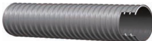
**Gaine pour air****Construction:** PVC gris - résistant à l'abrasion et à l'ozone**Armature:** PVC blanc rigide résistant aux chocs**Utilisation:** Extraction d'air, gaz et fumée. Climatisation et ventilation**Températures:** -10 °C +60 °C (+14 °F +140 °F)
