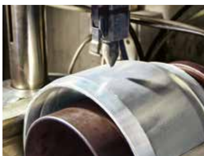
2. Marquage de la douille pour une traçabilité complète
