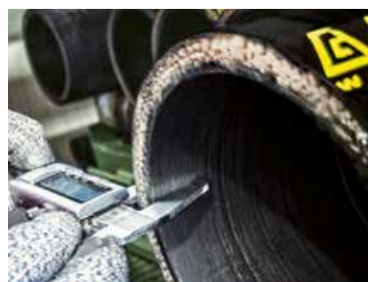
3. L'épaisseur du tuyau est mesurée pour obtenir le diamètre correct de sertissage
