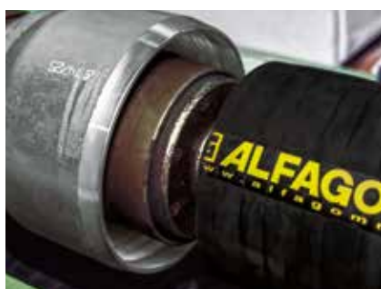
4. Insertion du raccord dans le tuyau
